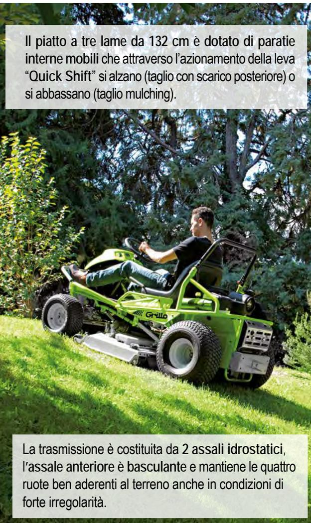
La trasmissione è costituita da 2 assali idrostatici, l'assale anteriore è basculante e mantiene le quattro ruote ben aderenti al terreno anche in condizioni di forte irregolarità.
