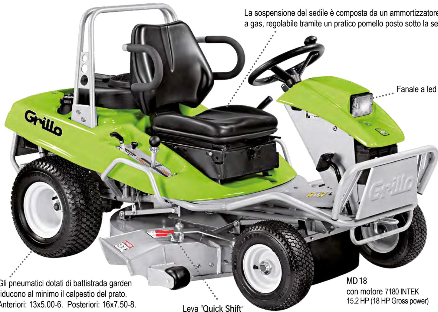
La sospensione del sedile è composta da un ammortizzatore a gas, regolabile tramite un pratico pomello posto sotto la seduta.
