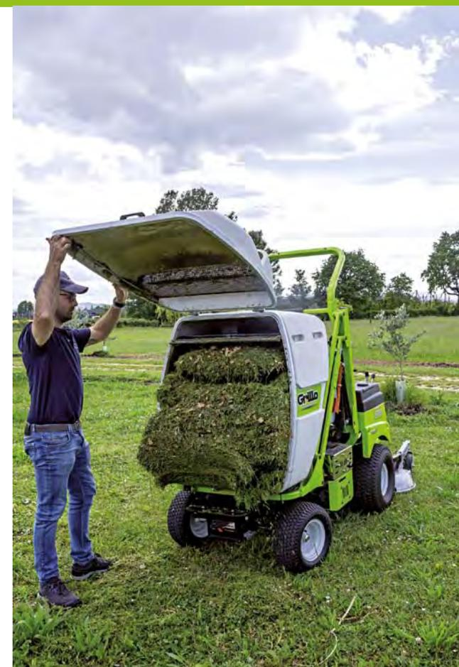
L'azionamento dei servizi idraulici per sollevare e ribaltare il cesto si effettua dal posto di guida tramite comode leve che rendono le operazioni di scarico dell'erba e di rientro nella posizione di lavoro estremamente fluide e veloci. Una terza leva permette di sollevare idraulicamente il piatto per spostarsi e superare agevolmente cordoli ed ostacoli.
